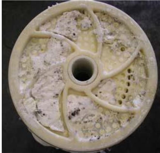
Figure 8. Photo d'un module colmaté par des substances inorganiques
