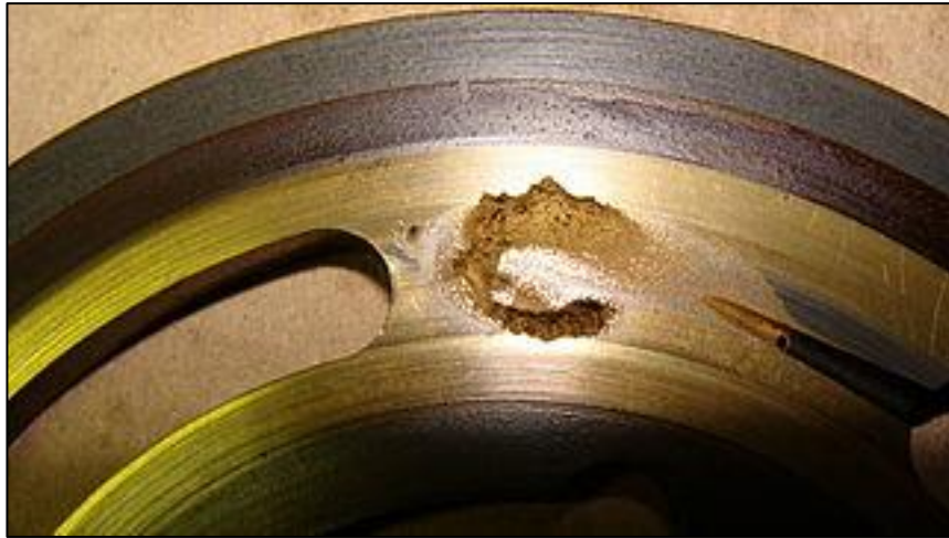
Figure III.10 : usure due au phénomène de la cavitation [38]
