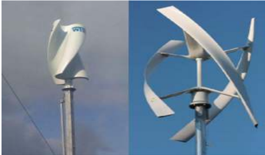
FIGURE I.14 : L'éolienne à axe vertical de type Savonius
