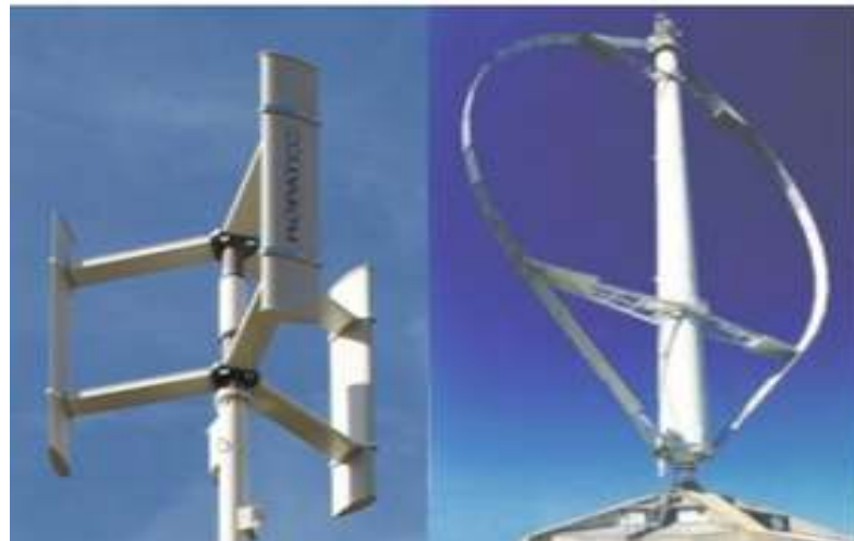
FIGURE I.15 : L'éolienne à axe vertical de type Darrieus
