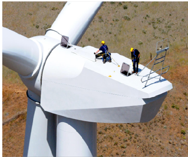
FIGURE I.20: La nacelle éolienne.
