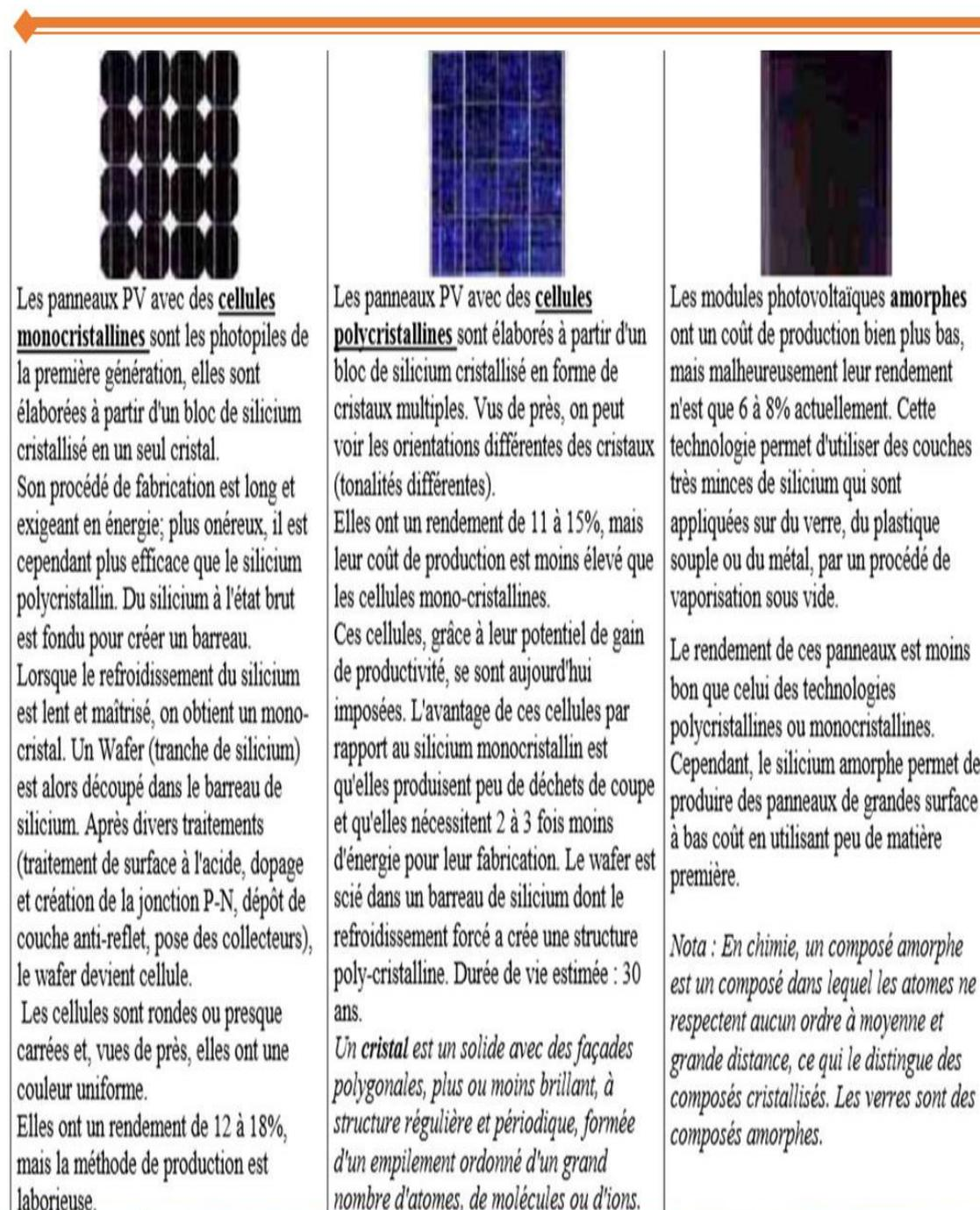
Figure.I. 13: les types des cellules photovoltaïques
