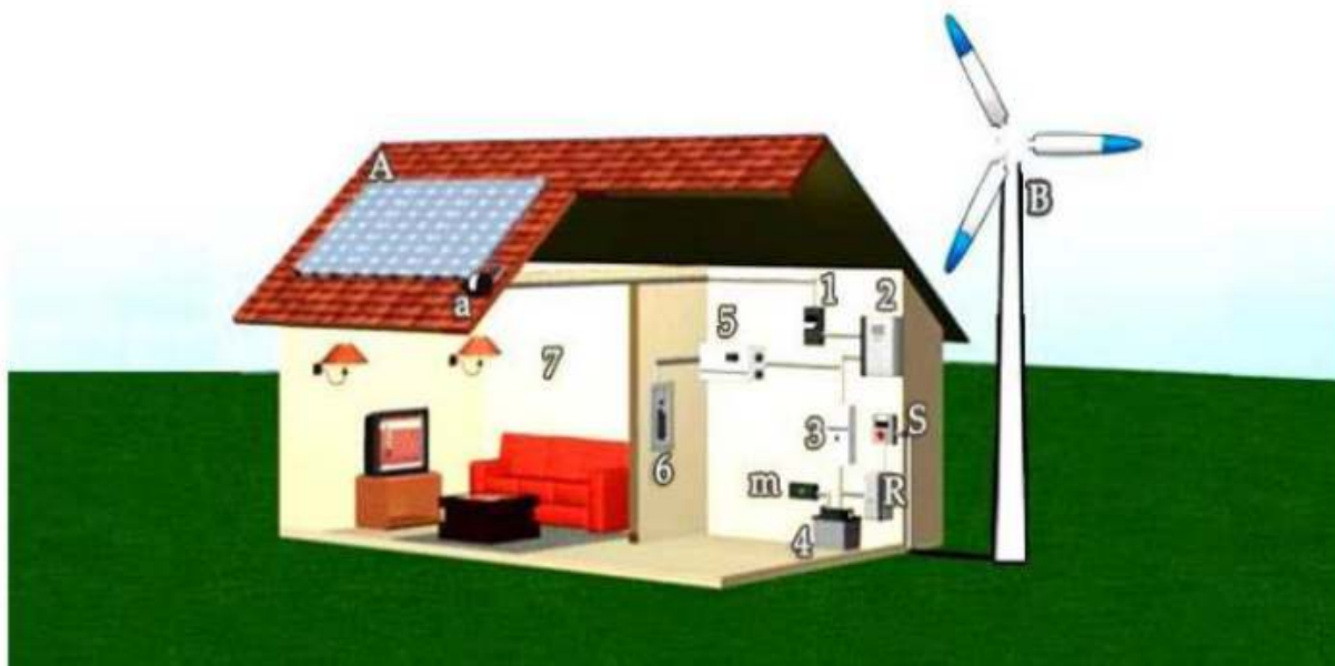
Figure.II.1 : Système d'énergie hybride photovoltaïque-éolien. [24]
